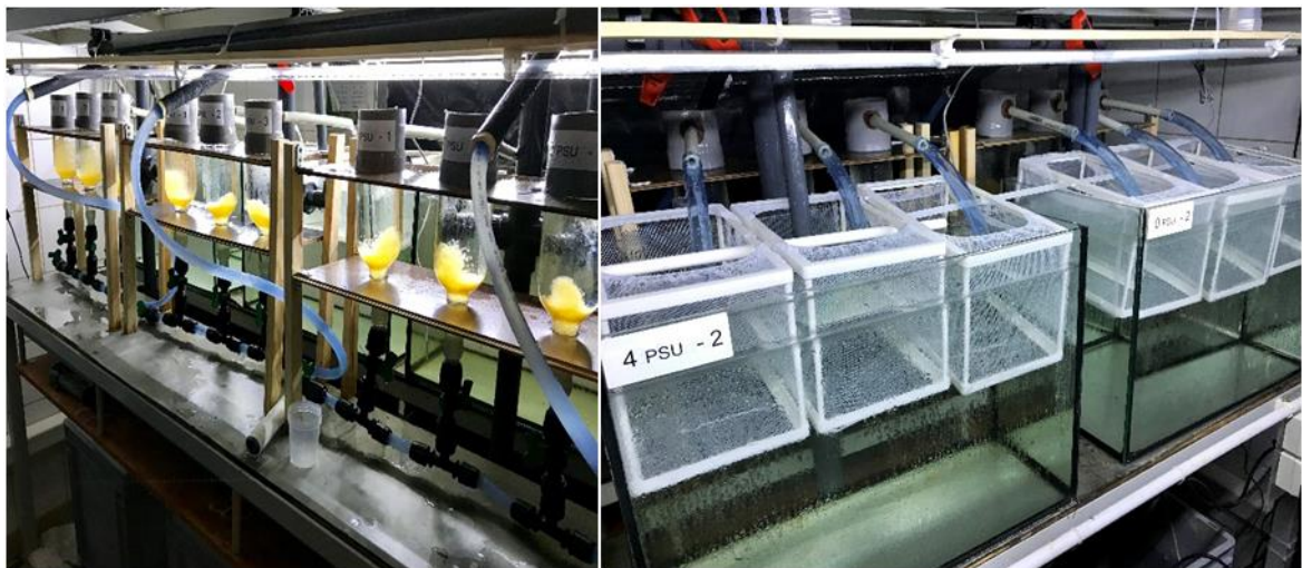
Rys. 7. System eksperymentalny, inkubacja ikry w różnych wariantach zasoleniowych.
