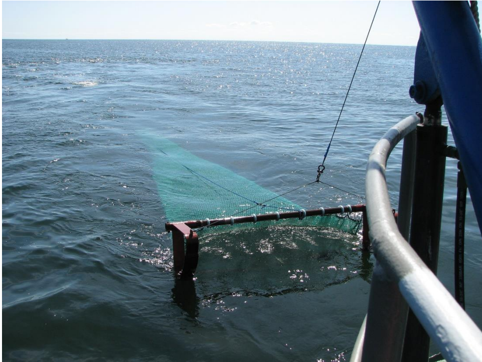
Ryc. 3.7. Opuszczenie włoka rozprzewego na dno, (fot. M. Sapota)
