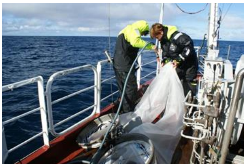
Ryc. 3.14. Sieć planktonowa typu Bongo w trakcie płukania, (fot. A. Panasiuk)
