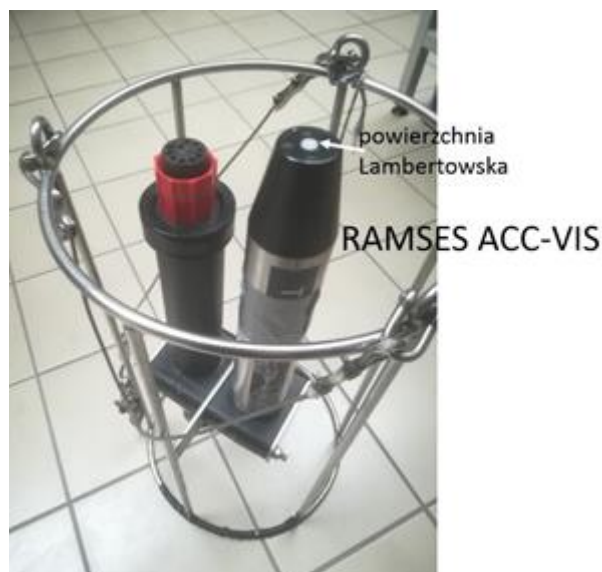
Ryc. 3.22. Miernik oświetlenia RAMSES ACC-VIS ustawiony do pomiaru oświetlenia odgórnego, (fot. M. Misiewicz)
