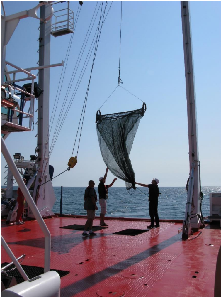
Ryc. 3.8. Włok rozprzowy podniesiony ponad rufę jednostki połowowej, (fot. A. Dziubińska)
